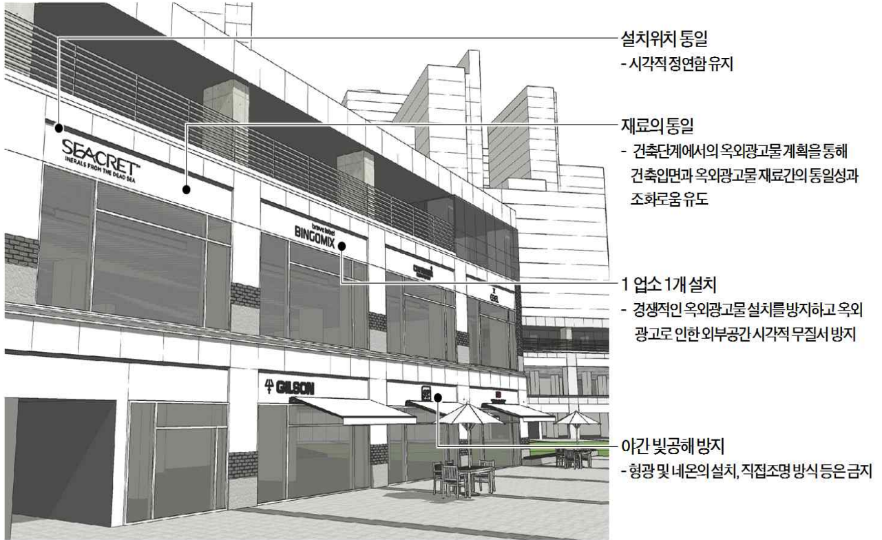
<그림 III-5-1> 옥외광고물 설치 세부가이드라인
