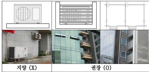
[그림38] 실외기 설치 예시도
